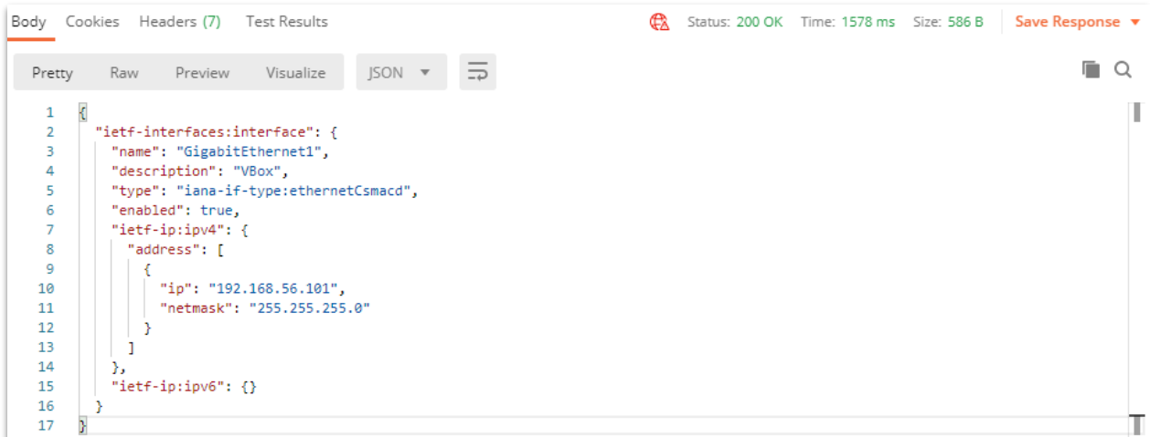
Obrázok 1.5 Prostredie Postman – odpoveď GET požiadavky pre konkrétne rozhranie GigabitEthernet1
